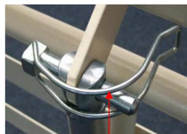
Soporte de seguridad bloqueado
